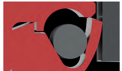
Bei niedriger Drehzahl liegt die Dichtlippe an
