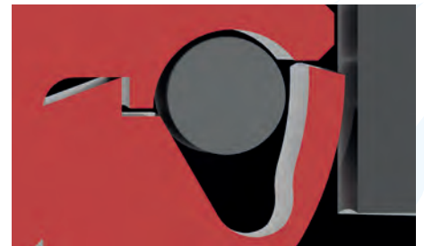
Bei hoher Drehzahl hebt die Dichtlippe ab
